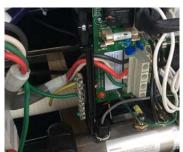
追加、中継端子台に電源線を接続した参考図です。 N相(接地側)を直接コントロールBOXへ接続される場合、 中継端子台の端子数はL相(非接地側)のみの分岐となりますので3端子でも可能です。
