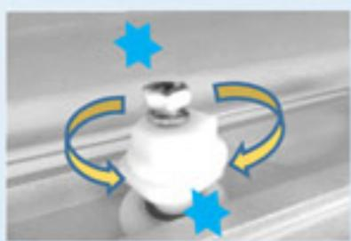
金属ナットが手締め程度で『F11：扉ローラー』の樹脂六角パーツが360度回転する間に、取付したガラス穴に対して『F11：扉ローラー』が上下に移動する事でガラス扉の傾き・高さの調節が出来ます。
