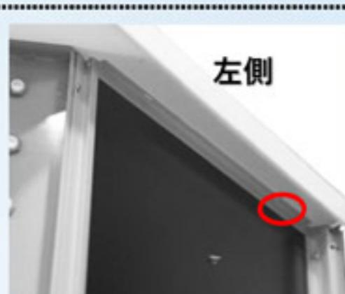
①位置決め後にマジックでBACKフレーム長穴に穴開け用の印を付けます。
